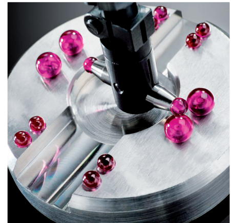
Beispiel eines Lückennormals mit drei gewählten Kugelquartetten für Gewindesteigungen von 1 mm bis 6 mm
