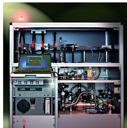
^{129}\text{Xe} -Polarisator der PTB, in den das Gas-trennmodul als Subkomponente integriert wird
