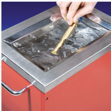
Neues Messgerät im Einsatz: Bestimmung der Reinigungswirkung von Ultraschallbädern
