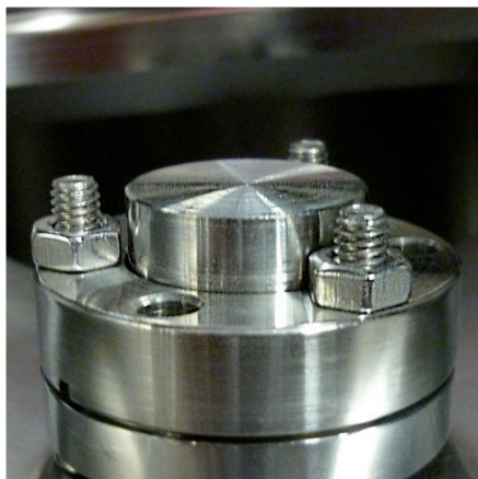
Kleinste Ausführung (Durchmesser 34 mm) einer Referenzausgasungsprobe für Wasserdampf mit 6 \cdot 10^{-7} mbarL/s
