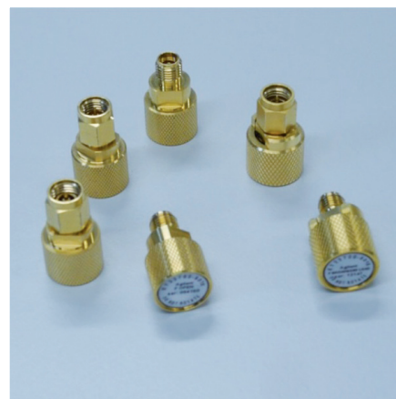
Koaxiale Kalibrierstandards zur Kalibrierung vektorieller Netzwerkanalysatoren
