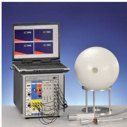
Halbleiter-Neutronenmonitor für gepulste Strahlenfelder mit Moderatorkugel
